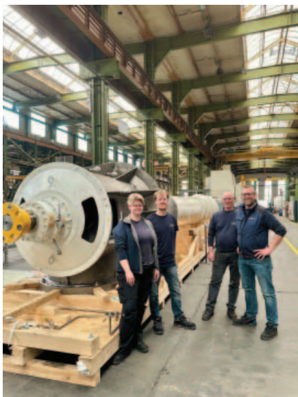
V. li.: Nina Frank, Lennard Vogt, Frank Bertram und Tobias Rieske vor der 21 Meter langen Kühlwasserpumpe. Das System wird Teil einer Anlage in der Nordsee.
